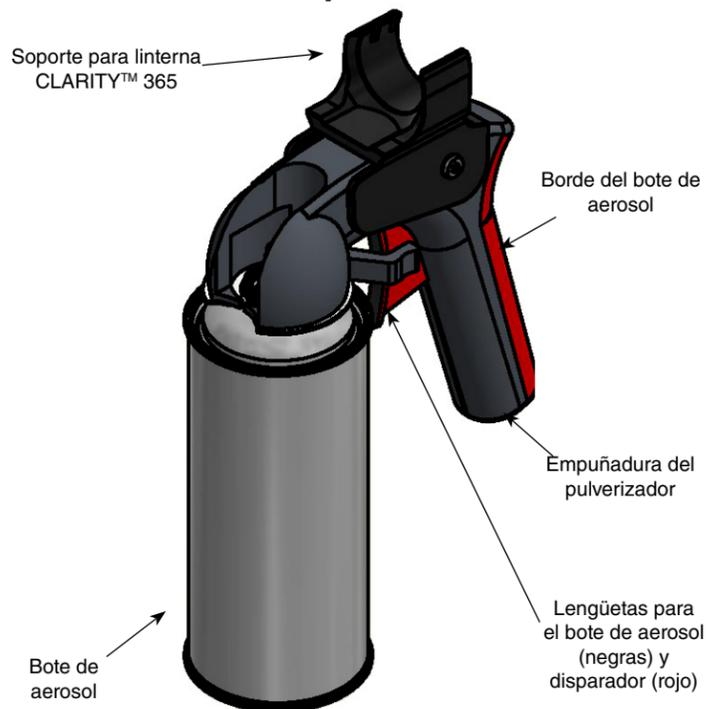
La empuñadura de bote de aerosol (RP-SM-01) está diseñada para sostener la linterna CLARITY™ 365 y un bote de aerosol al mismo tiempo con el fin de realizar la inspección fluorescente con una sola mano.
