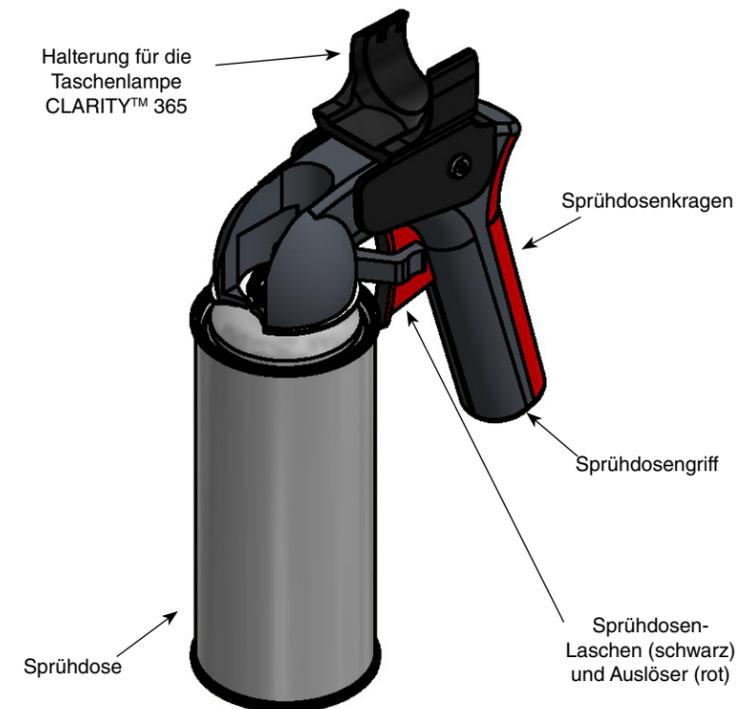
Zur einhändigen Fluoreszenzinspektion ist der Sprühdosenhalter (RP-SM-01) für die Aufnahme der CLARITY™ 365 Taschenlampe und eine Sprühdose gleichzeitig konstruiert.
